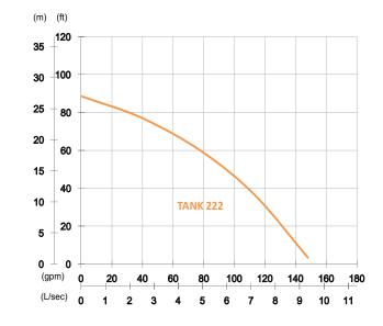
Shaft Speed : 3450 rpm
